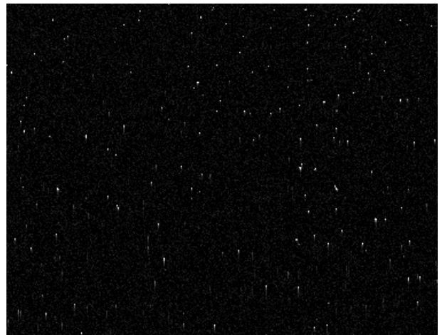
A sinistra, un dark frame singolo ripreso il 6 febbraio, con un minuto di integrazione a otturatore chiuso. Il risultato sembra simile al bias frame. A destra ho mediato 20 dark frame (master dark) e ho sottratto il master bias, in questo modo la media degli ADU è circa 0 mentre si nota l'effetto dei pixel caldi, che raggiungono i 10000 ADU
